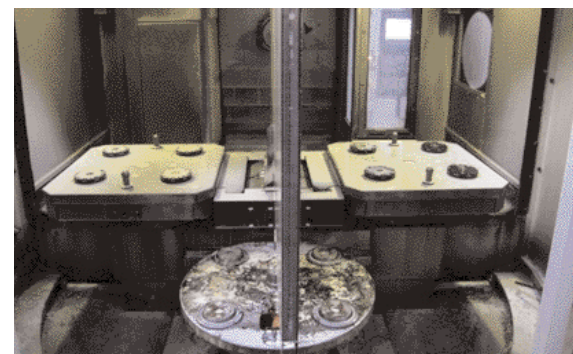
2 Pro Maschine wurden zwei Grundplatten mit je vier NSM-HV 20 fest auf den Maschinen-Wechselpaletten montiert
